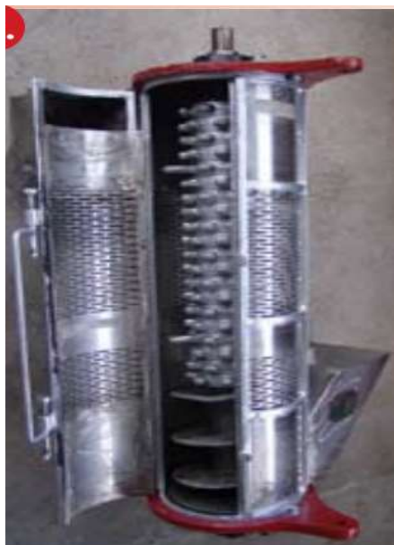
Photo 11 : structure d'un démulagineur mécanique
