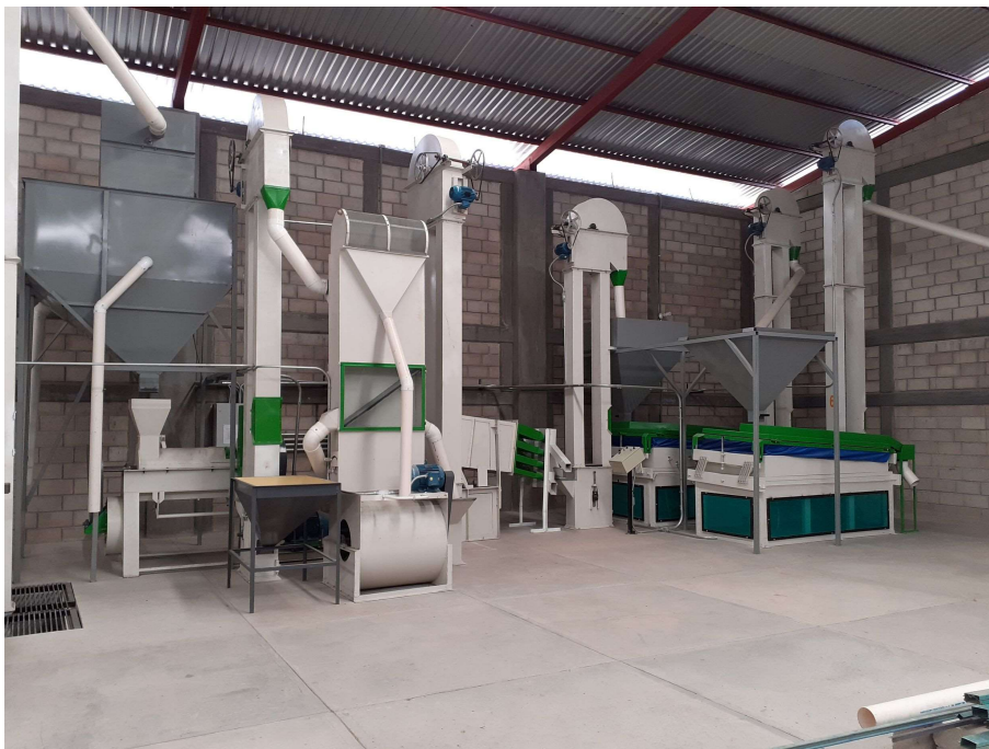
Photo 12 : Usine de préparation du café vert 1,5t/h, Pinhalense
