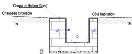
FIGURE 4:FOSSÉ TYPE RECTANGULAIRE (MAÇONNÉ)
