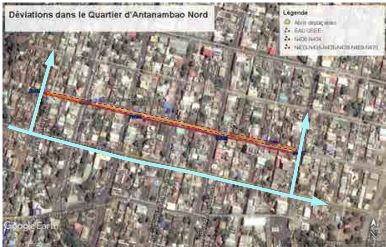
FIGURE 10 : RUE A BLOQUER A TANAMBAO NORD ET DEVIATIONS POSSIBLES DURANT LES TRAVAUX
